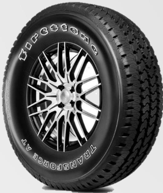
La Transforce AT fue desarrollada para desempeño en todo tipo de terreno, sus costillas continuas con ranuras profundas proporcionan una excelente tracción en pavimento seco y mojado, además de reducir el desgaste irregular combinando así un diseño ideal de banda de rodamiento.
