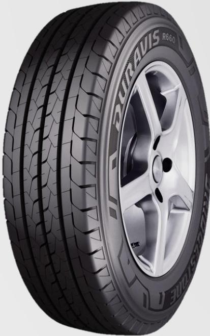
La llanta Bridgestone DURAVIS R660 está orientada vehículos de transporte ligeros, Vans y de reparto; su diseño de banda de rodadura contribuye a disminuir el desgaste irregular incrementando la vida útil del neumático, asimismo, la estructura reforzada de los costados incrementa la resistencia a daños provocados por impactos
